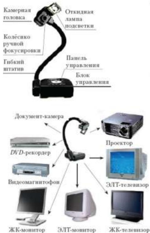
Документ-камера это цифровое устройство, объединяющее в себе кодоскоп, сканер и видеокамеру с возможностью подключения к любому устройству, воспроизводящему изображение
