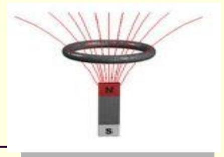
направление индукционного тока в контуре зависит от того, возрастает или убывает магнитный поток, пронизывающий контур. Наиболее общее правило, позволяющее определить направление индукционного тока, было установлено в 1833г. Э.Х.Ленцем.
